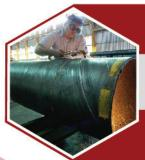
Tubería de acero con costura helicoidal y longitudinal (SAW) en espesores máximo hasta 1" desde 16" hasta 120" de diámetro bajo normas API y AWWA.
