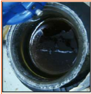
Figura 8. Ausencia de sólidos dentro del sistema experimental de hidratos de THF
