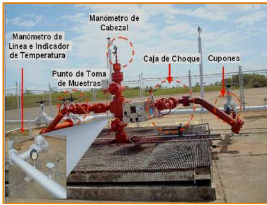
Figura 5. Esquema del pozo productor con inyección a superficie en el Oriente
