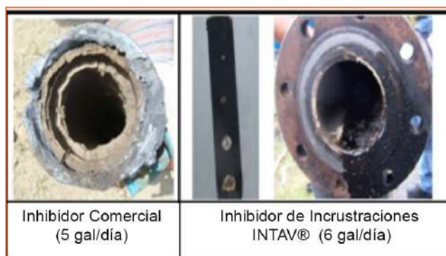
Figura 8. Evaluación del INTAV® en un pozo productor de los Llanos Centrales de Venezuela
