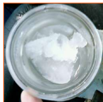
Figura 4. Presencia de sólidos dentro del sistema experimental de hidratos de THF
