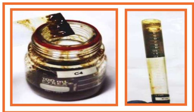
Figura 1. Simulación de la interacción fluido de formación + fluido de perforación + fluido de completación + fluido de estimulación en el pozo JM-264
