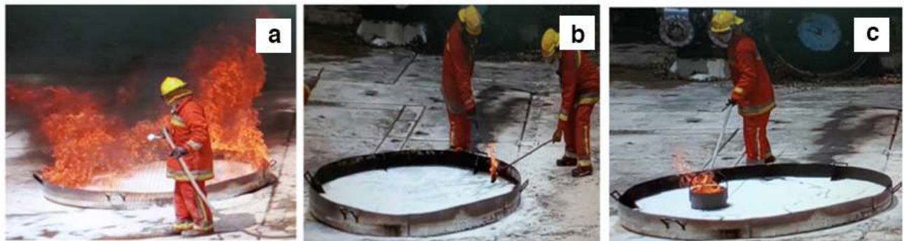
Figura 4. Método de aplicación turbulenta concentrado de producción internacional: (a) ensayo de extinción de incendio, (b) ensayo de sellado, (c) ensayo de reignición
