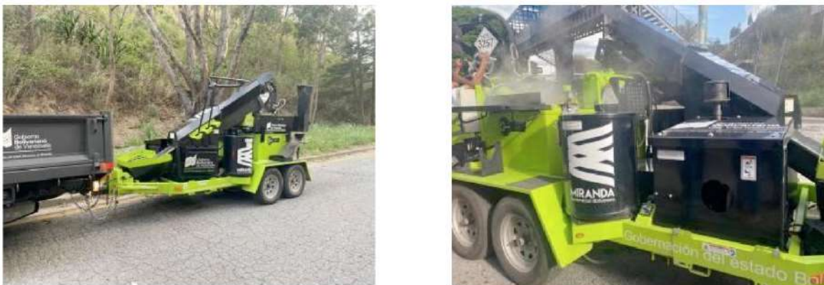
Figura 2. Máquina mezcladora y aplicador de sellos CIMLINE C1 de tecnología norteamericana
