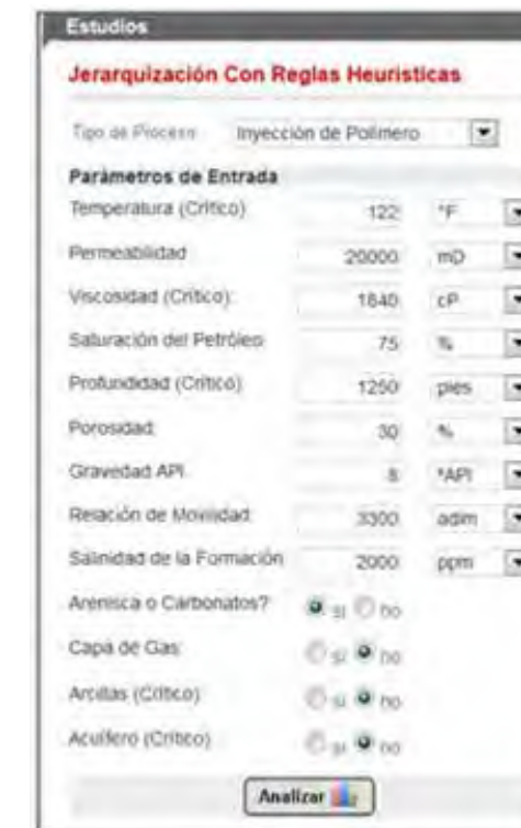
Figura 7. Datos de entrada para la evaluación del sector fluvial del yacimiento del área de Petrocedeño con el proceso inyección de polímero, módulo de reglas heurísticas ©SIJERM. Utilizando viscosidad de crudo vivo.
